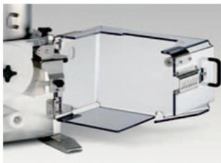
**Maximale Sicherheit!** Unsere Hamburgermaschinen sind mit allen nützlichen Vorkehrungen zur Erhöhung der Sicherheit ausgestattet. Die Vitrine deckt alle laufenden Teile ab und erlaubt die maximale Sicht auf den laufenden Prozess.
