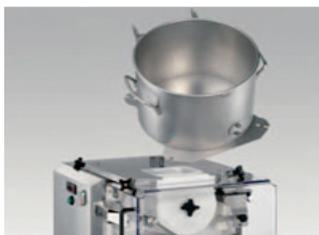
Die INOX Wanne ist komplett ausziehbar, um die Reinigung zu erleichtern. Alle Komponenten, die in Kontakt mit Fleisch oder anderen Zubereitungen treten, sind für Lebensmittel nach der HACCP Prozedur zugelassen.
